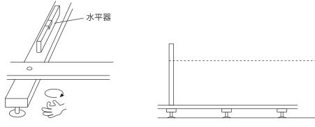
かね尺等を支持脚上に立て、手でボルトを回し、 同じ位置にレーザーがあたるように高さを調整します。
