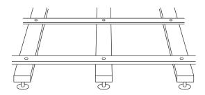
②両端の根太のレベルを出します。
