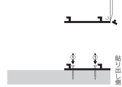
②T 字加工されたデッキ材をはめ込みます。 (\*ユ部を溝の深い方向へ差し込みます。)
